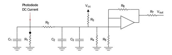
$$\text{Output voltage} \quad \text{$V_{\text{out}} \coloneqq \left(R_1,\, R_2,\, R_3,\, R_4,\, R_5,\, R_6,\, R,\, V_{\text{cc}},\, P\right)$} \quad \frac{\left(\left(P \cdot R \cdot R_3 + V_{\text{cc}}\right) \cdot R_1 + V_{\text{cc}} \cdot R_2\right) \cdot R_4 \cdot \left(R_5 + R_6\right)}{\left(R_1 \cdot \left(R_3 + R_4\right) + \left(R_2 + R_4\right) \cdot R_3 + R_2 \cdot R_4\right) \cdot R_5}$$
